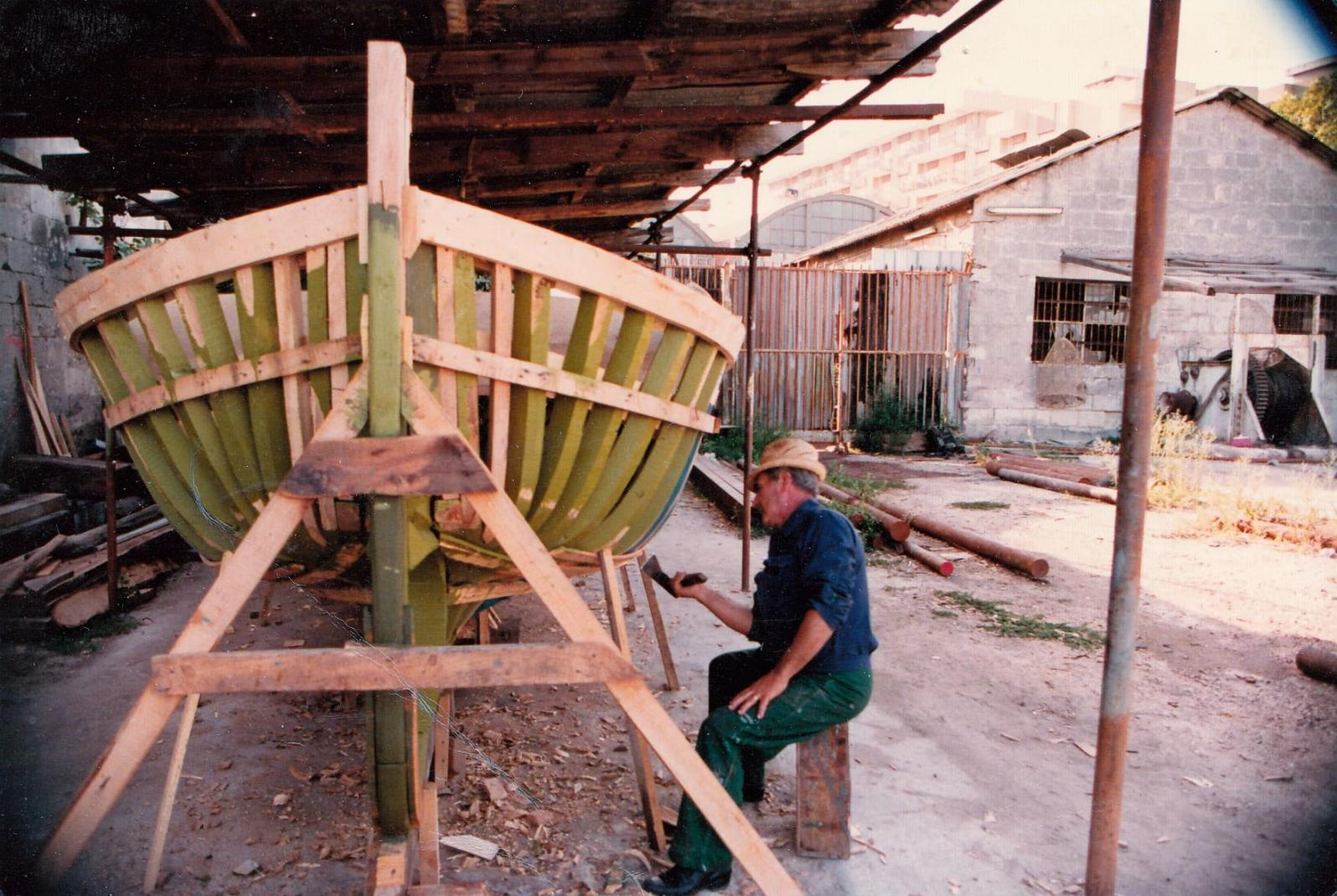
3 Raccordo esterno con l'ascia delle ordinate (ossature) (foto C. Portacci)
